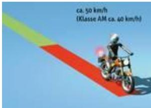
Der Bewerber hat das Kraftrad unter gleichzeitiger Benutzung beider Bremsen mit höchstmöglicher Verzögerung aus einer Geschwindigkeit von ca. 50 km/h (bei Klasse AM aus ca. 40 km/h) zum Stillstand zu bringen, ohne dass das Kraftrad dabei wesentlich von der Fahrlinie abweicht.
