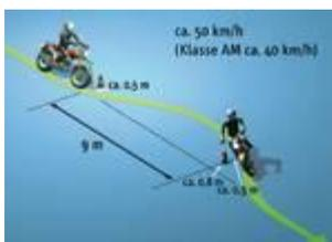
Beschleunigen auf etwa 50 km/h (bei Klasse AM auf etwa 40 km/h), vor einer markierten Stelle um etwa 1 bis 1,5 m nach links ausweichen und, ohne zu bremsen, auf die ursprüngliche Fahrlinie zurückkehren. Das Ausweichen darf frühestens 9 m vor der markierten Stelle beginnen.
