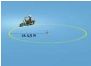
Einfahren in einen Kreis mit einem Halbmesser von 4,5 m (eine Markierung des Kreises ist nicht erforderlich), mehrfaches Kreis fahren und Verlassen des Kreises. Die Geschwindigkeit ist so zu wählen, dass Schräglage entsteht.
