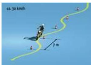
Der Bewerber hat eine Slalomstrecke (Länge ca. 50 m, 5 Leitkegel, Abstand 7 m, Aufbau siehe Skizze) mit einer Geschwindigkeit von ca. 30 km/h zu durchfahren.
