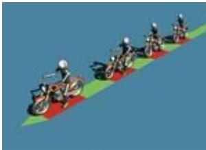
Mehrfaches Anhalten und Anfahren, abgestimmtes Betätigen von Gas, Kupplung und Bremse, Füße nur zum Abstützen des Kraftrades im Stand von den Fußrasten nehmen und auf die Fahrbahn absetzen. Dabei zunächst zweimal den einen und dann zweimal den anderen Fuß absetzen.
